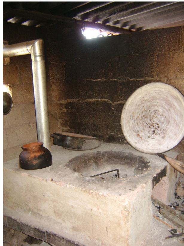
Figura 36. Estufa en Xalpatláhuac. Se puede apreciar que han sido reemplazados los comales secundarios por ollas de barro. También es posible ver un triángulo dentro de la cámara de combustión que se utiliza para la nixtamalización.
