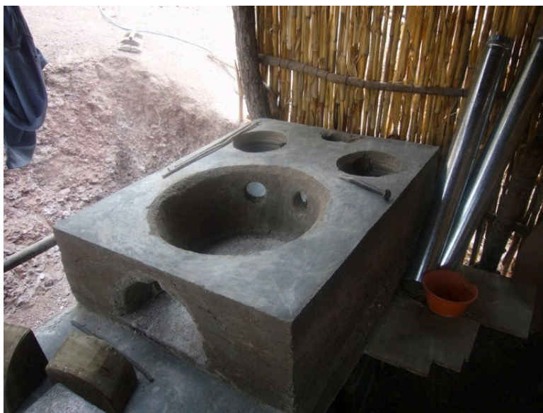
Figura 4. Fotografía del prototipo de Estufa Eficiente Xalpaneca . La estufa contó con cámara de combustión y entrada de leña amplia, dos hornillas secundarias y chimenea. Enero de 2010.
