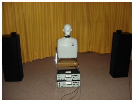
Figura 8.9: Disposición de los bafles, maniquí y amplificadores de medición en el recinto acústicamente amortiguado en sistema binaural.
