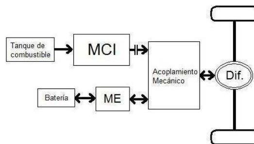
Figura 1.2: Configuración Paralela.
