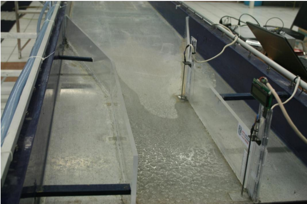
Figura 2.15 Imagen que muestra el limnómetro electrónico, colocado aguas abajo de la cortina y sobre la sección de control
