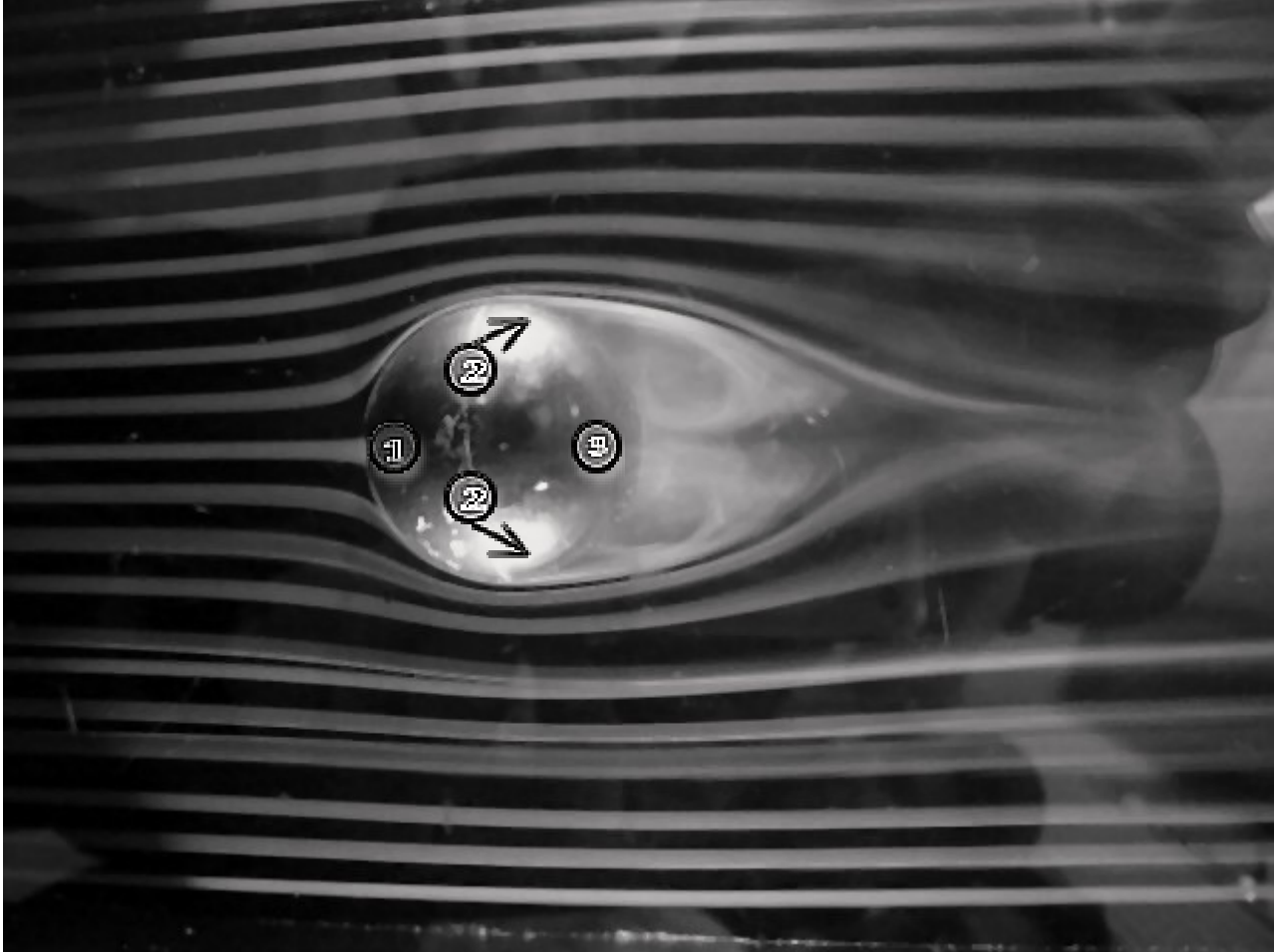
Figura 13.- Visualización de líneas de trayectoria en aire alrededor de una esfera en flujo laminar. Foto tomada del Laboratorio de Termo fluidos, FI UNAM, a cargo del Dr. Francisco Solorio.
