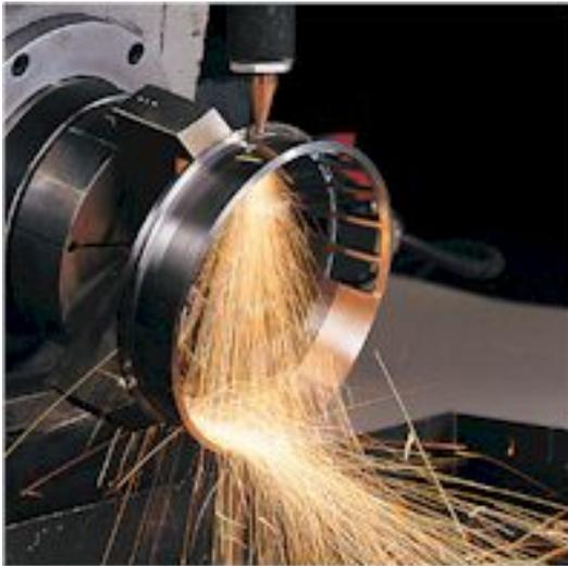
▲ **Figura 1.1.** Manufactura de acero por medio de método de arranque de viruta en torno.
