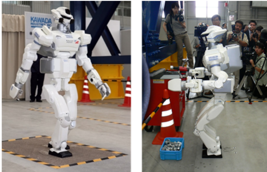
Figura 1.7: Humanoide HRP-3 en el laboratorio de mecatrónica de Kawada, caminando sobre una superficie con poca fricción y manipulando un taladro para el ajuste de piezas.
