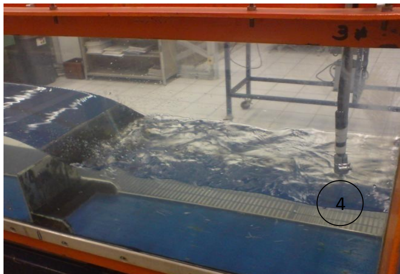
Imagen A.2.4.1 Localización del punto de medición 4, después de salto hidráulico
