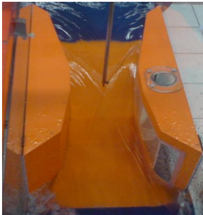
Imagen A.3.3 Canal Parshall usado para acelerar el flujo en la sección intermedia del canal rectangular y provocar un segundo salto hidráulico en el recorrido del fluido
