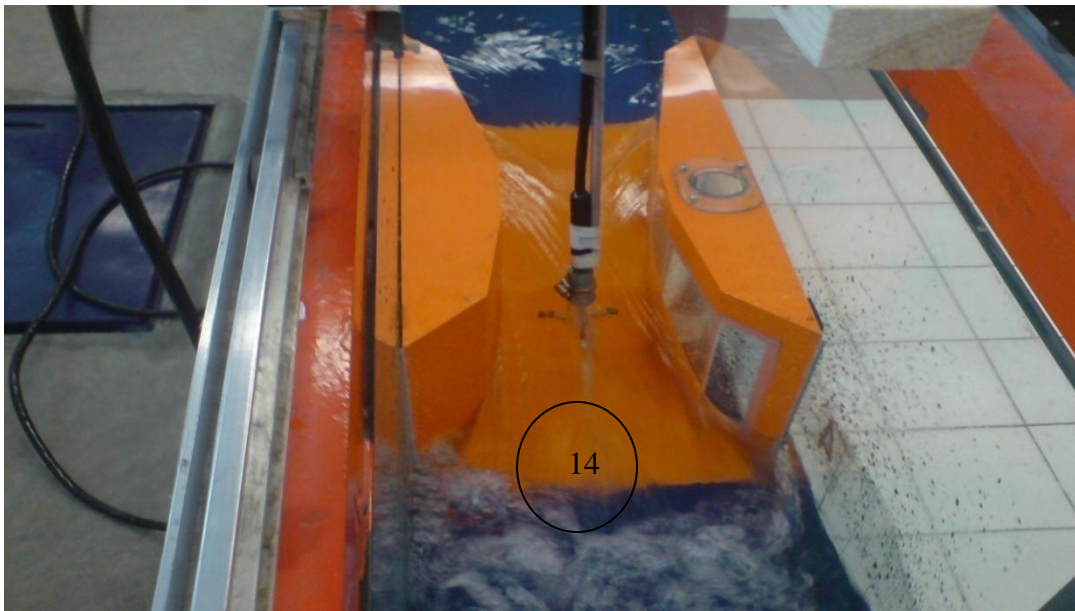
Imagen A.3.7 Vista desde aguas abajo hacia canal Parshall, donde se observa el comportamiento del flujo
