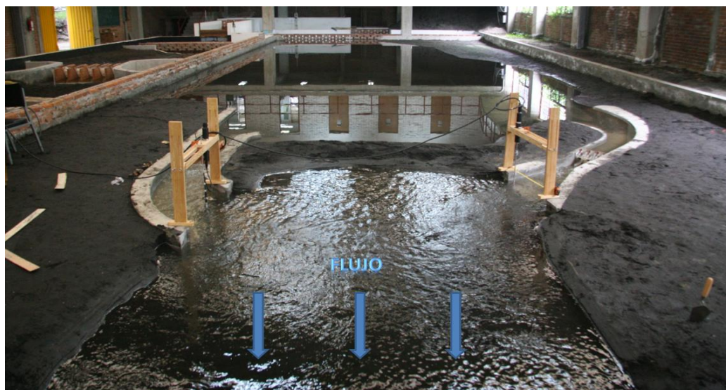
Imagen 7.1.3 Funcionamiento conjunto del gasto de diseño en ambas estructuras
