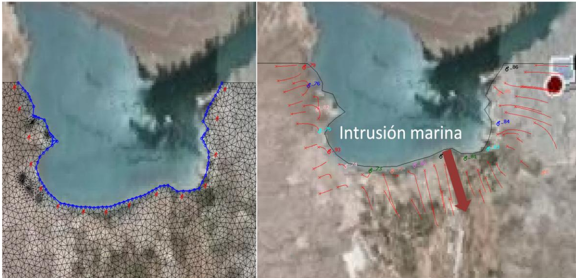
FIGURA 3.9 BATERÍA DE ALIMENTACIÓN A LO LARGO DE LA LÍNEA DE COSTA (izquierda) Y LÍNEAS DE CORRIENTE FLUYENDO HACIA TIERRA ADENTRO (derecha)
