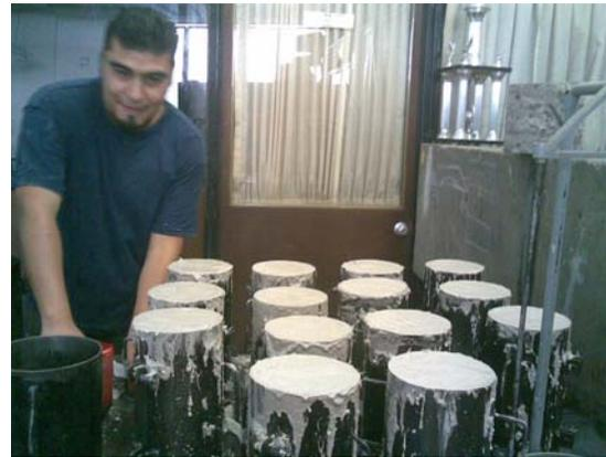
2. Se almacenaron los cilindros en el cuarto de curado bajo condiciones estándar de humedad y temperatura.
