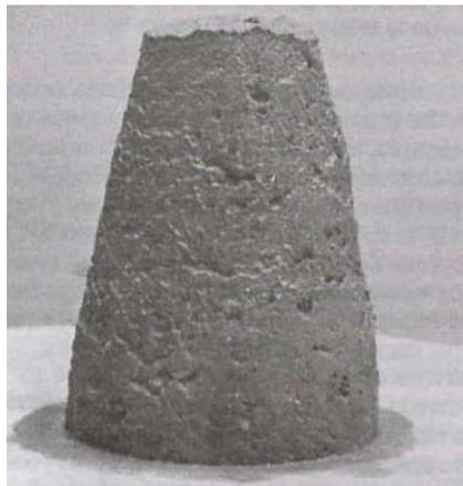
Fig. 1. Concreto con bajo revenimiento.
