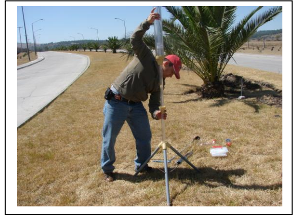
Figura No 10. Armado del permeámetro de Guelph.
