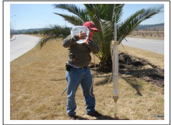
Figura No 12 Colocación del permeámetro sobre el agujero y llenado con agua limpia.
