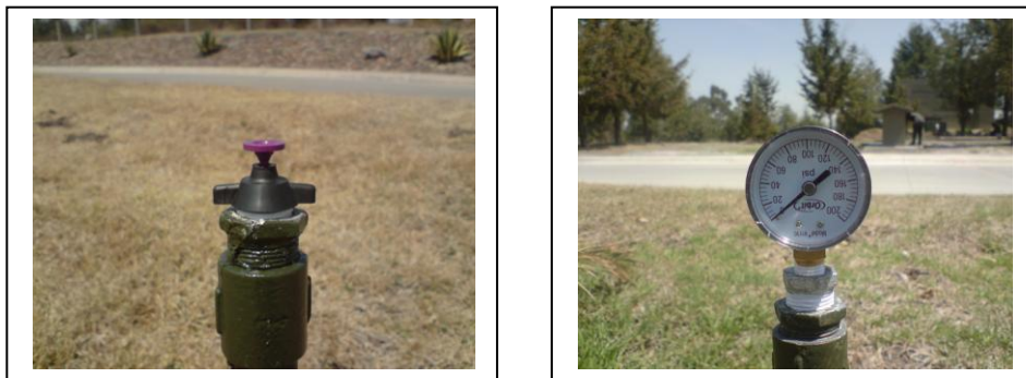
Figura No. 4. Colocación de un manómetro para la toma de lectura de la presión en ese punto.
