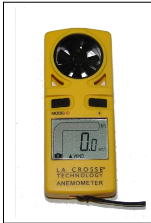
Figura No. 7. Anemómetro empleado para tomar la velocidad del viento y temperatura en el momento de cada prueba.
