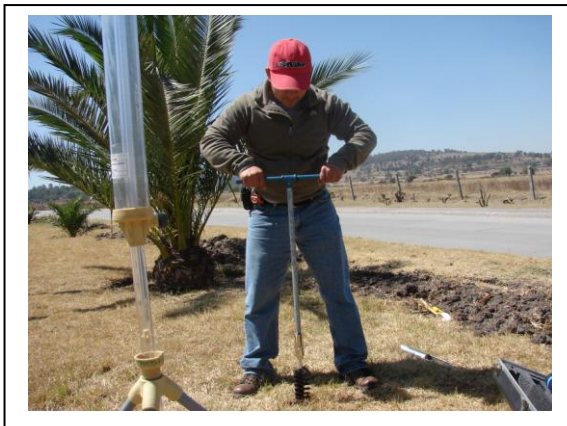
Figura No.11. Perforación del agujero.
