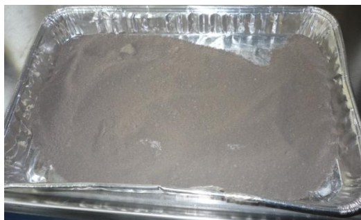
Figura 7.4.- Suelo después de lavado mecánico
