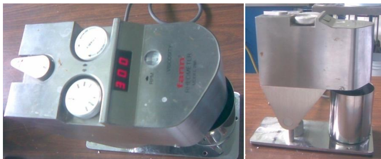
Figura 7.7.- Reómetro Fann en operación
