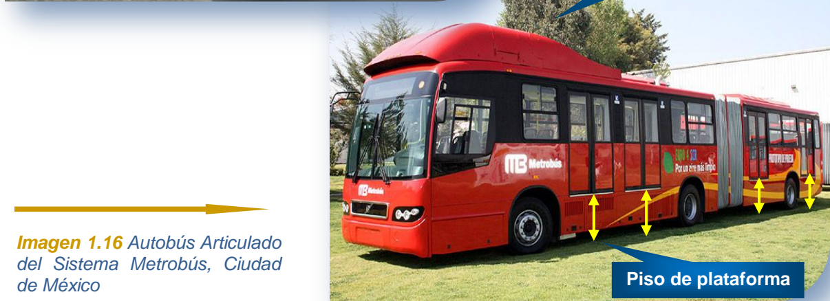
Autobús Articulado de la marca Volvo, modelo 7300, piso de plataforma
