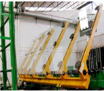
Figura 17. Succión para corte del vidrio
