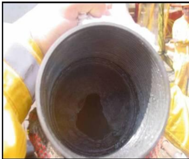
Fig.-1 Parafina obstruyendo una tubería de producción
