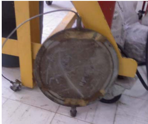
Figura 2.8 Celdas de presión utilizadas por la CFE
