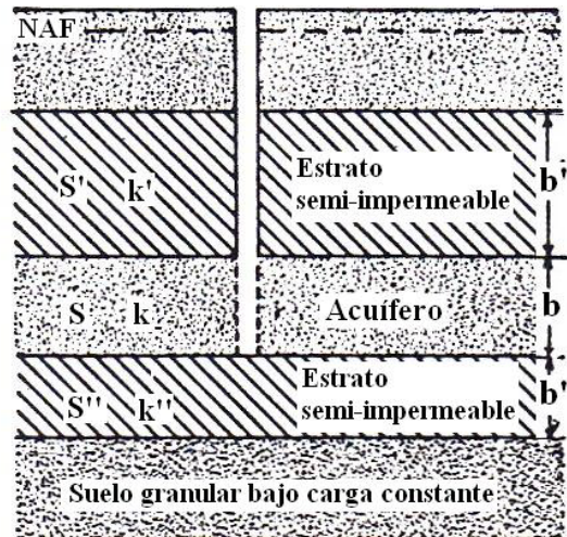
Figura A.4.4. Acuífero ubicado entre estratos semi-impermeables, ubicados a su vez entre acuíferos con carga constante
