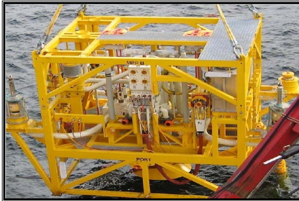
Fig. 4.1 Módulo de bombeo multifásico
