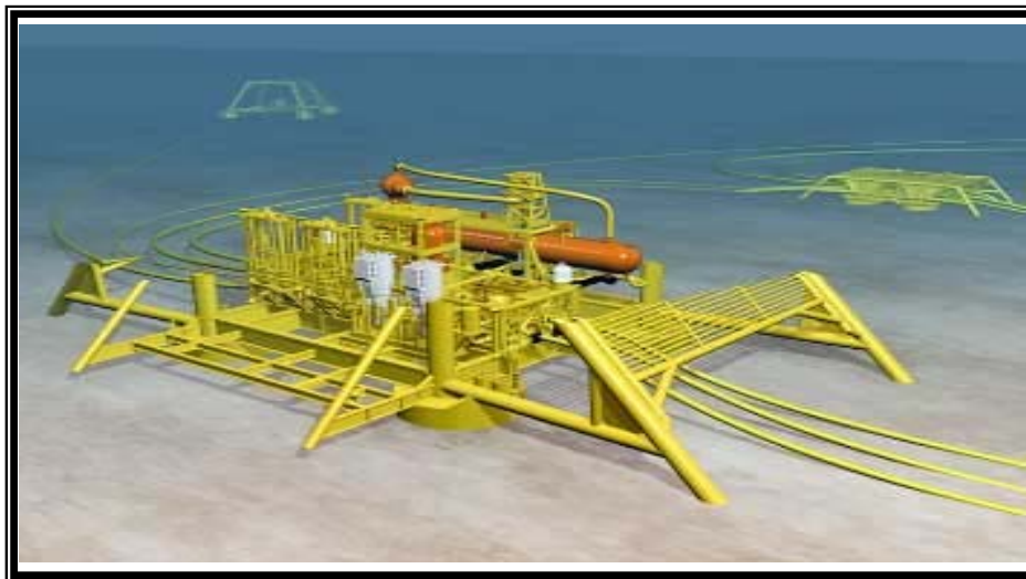
4.8 Módulo que contiene separación, reinyección y bombeo, FMC
