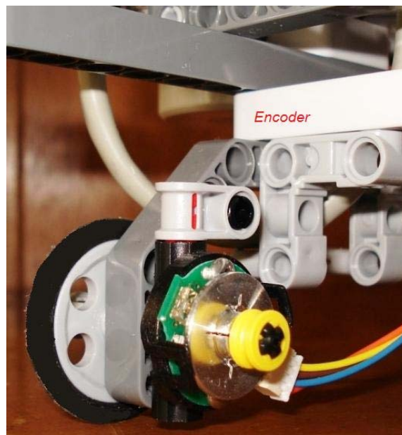
Figura 21. Foto de una llanta trasera y su encoder de cuadratura (modelo EP4). Para detalles ver US DIGITAL™ , 2009
