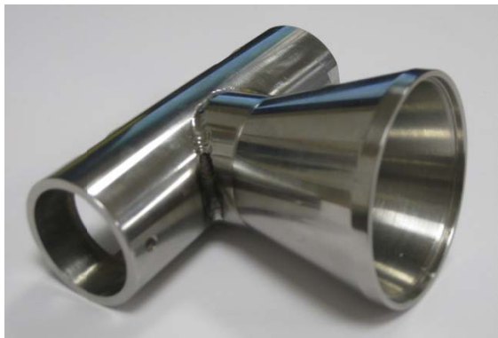
Figura 3.11. Tolva y carcasa fabricada en acero inoxidable para el tornillo de diámetro de 21 mm y paso milimétrico 9.
