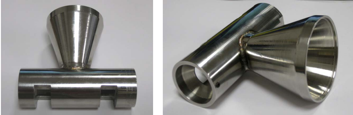
Figura 3.9. Tolva y carcasa fabricada en acero inoxidable para el tornillo de 14 mm de diámetro y paso milimétrico 6.
