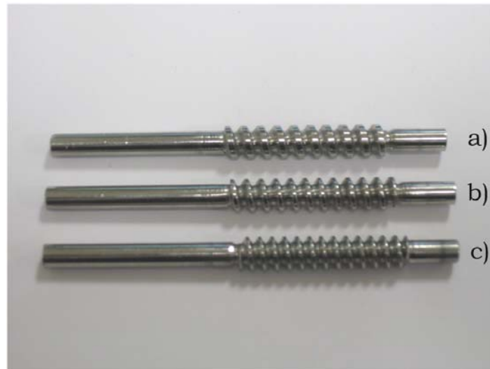
Figura 3.1. Tornillos dosificadores fabricados en acero inoxidable AISI 304 de 7 mm de diámetro. a) Paso 2.5. b) Paso 3. c) Paso 3.5.
