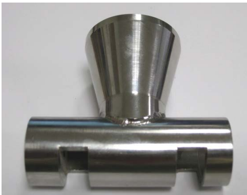
Figura 3.11. Tolva y carcasa fabricada en acero inoxidable para el tornillo de diámetro de 21 mm y paso milimétrico 9.
