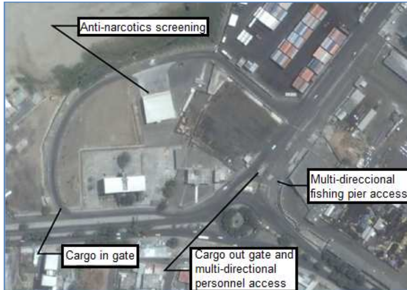
Figura 10 Puertas de acceso al puerto (Fuente: Puerto de Manta, Ecuador. Proyecto de expansión del puerto)
