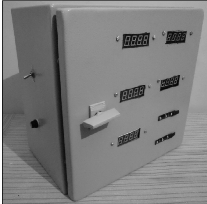
Figura 4.16 Armado final de sensado electrónico en gabinete de control
