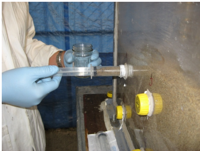
a) obtención de muestra por medio de jeringa introducida en puerto de muestreo.
