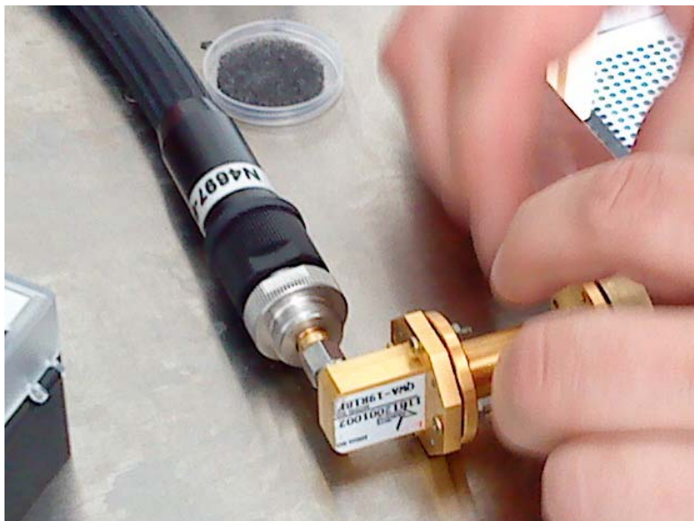
Figura 5-5. Medición realizada para prueba de calibración “short”
