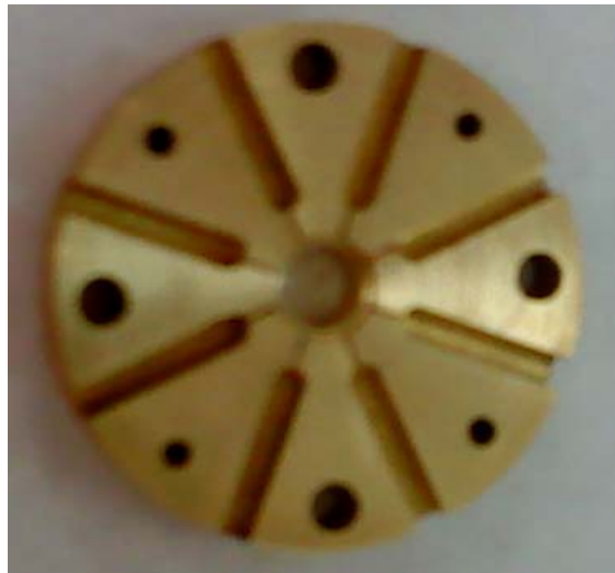
Figura 4-24. Dispositivo de montaje para diafragma de control
