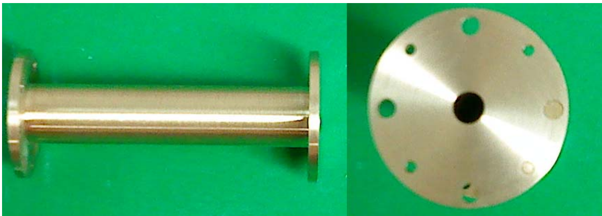
Figura 4-18. Vista superior y lateral de Guía de Onda utilizada para medición con “Carga Estándar”
