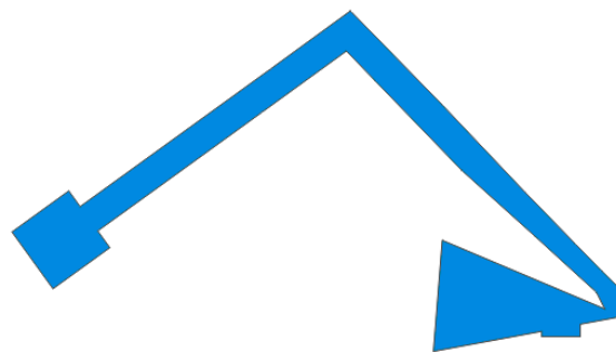
Figura 3-38. Filtro de DC con líneas de alimentación
