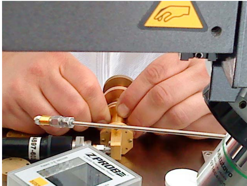
Figura 5-7. Medición de coeficiente de reflexión en prueba con “Carga Estándar”
