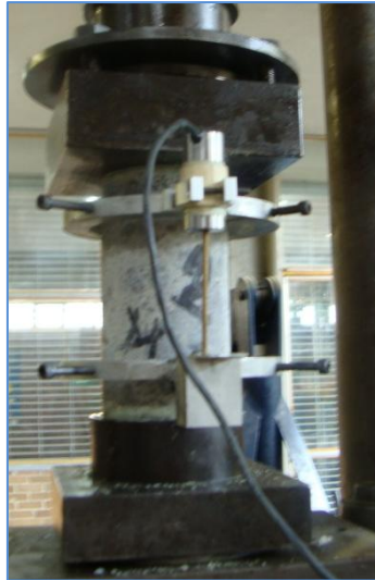
Figura 4. Se muestra la forma en la que se obtuvo la información de resistencia y comportamiento, este último dato se logro con la instrumentación que se muestra, basado en el uso de un LVDT. Conectado a un sistema de adquisición de datos con plataforma LabVIEW.
