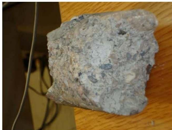
Figura b. La figura nos muestra un concreto muy granular y las partículas de arena con adherencia muy deficiente, lo que propicio que las muestras tuvieran que ser tratadas con extremos cuidados, de no ser así correríamos el riesgo de no poder analizarlas en su comportamiento, como sucedió con dos de ellas, al inicio se pensó que la delicadeza de las muestras obedecía a una pasta de cemento-agua de mala calidad, a fuerza de inspeccionar las muestras se encontró que su deficiencia radicaba en la selección del tipo de agregados (cantos rodados) y su deficiente graduación, las diferentes tonalidades en los agregados permiten establecer que varios minerales con diferentes características mecánicas conforman al concreto analizado.
