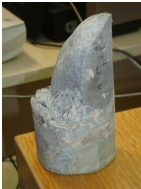
Figura 4.- Se muestra que el corazón fallado sufrió desprendimientos por falta de adherencia, impidiendo resistencias superiores
