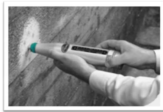
Figura II.IX Medición de la dureza del concreto con un esclerómetro
