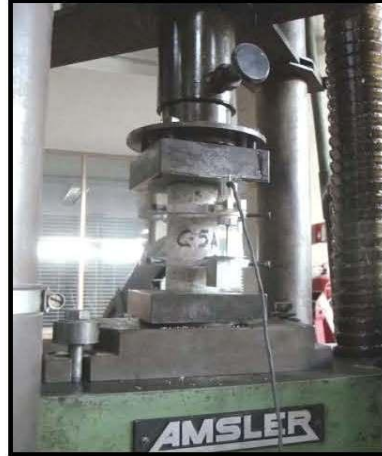
Figura 4. Se muestra la forma en la que se obtuvo la información de resistencia y comportamiento, este último dato se logro con la instrumentación que se muestra, basado en el uso de un LVDT. Conectado a un sistema de adquisición de datos con plataforma LabVIEW.
