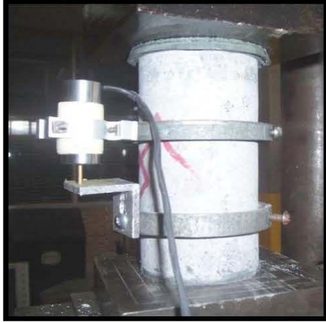
Figura 4. Se muestra la forma en la que se obtuvo la información de resistencia y comportamiento, este último dato se logro con la instrumentación que se muestra, basado en el uso de un LVDT. Conectado a un sistema de adquisición de datos con plataforma LabVIEW.
