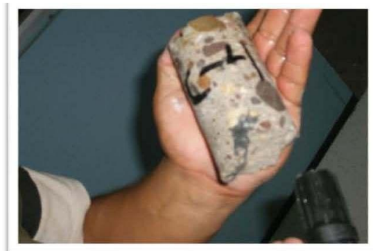
Figura II.X Extracción de núcleos de concreto
