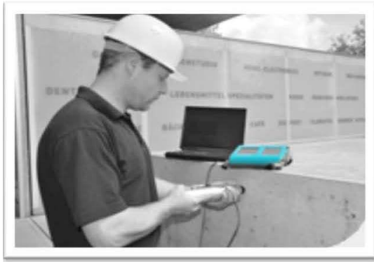
Figura II.IX Medición de la dureza del concreto con un esclerómetro
