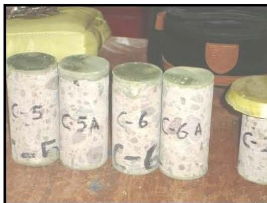
Figura 2. Se muestran algunos de los núcleos de concreto obtenidos de la estructura de la delegación ISSSTE.
