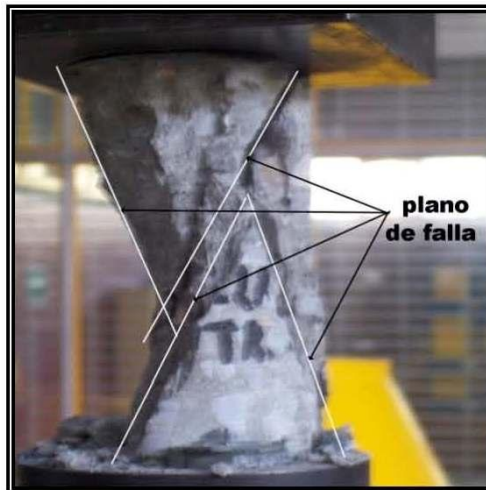
Figura 4.- Se muestra que el corazón fallado no sufrió desprendimientos por falta de adherencia, permitiendo resistencias superiores
