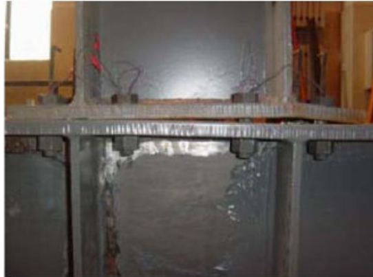
Fig.3.40 Espécimen fallado JD3, Shi et al (2006).
