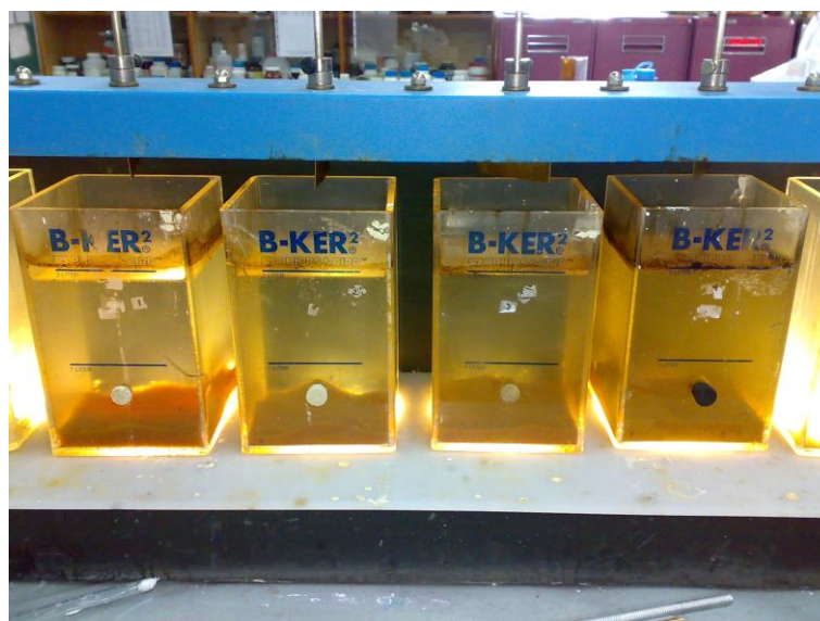
Figura 3.3. Generación de lodos en el reactivo de Fenton
