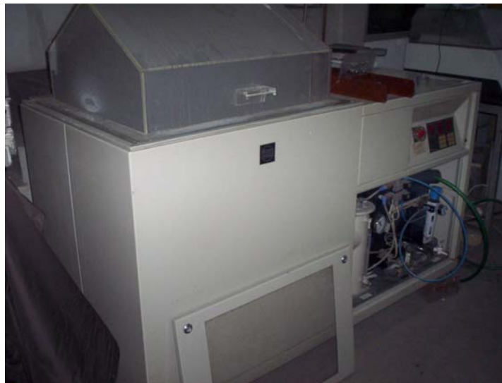
Figura 5.7. Cámara Salina Weiss Technik.
