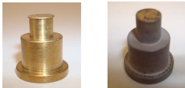
Figura 6.43. Vista lateral de la probeta de latón con el borde de material deformado plásticamente y vista superior de la probeta galvanizada con mejores resultados contra el desgaste.
