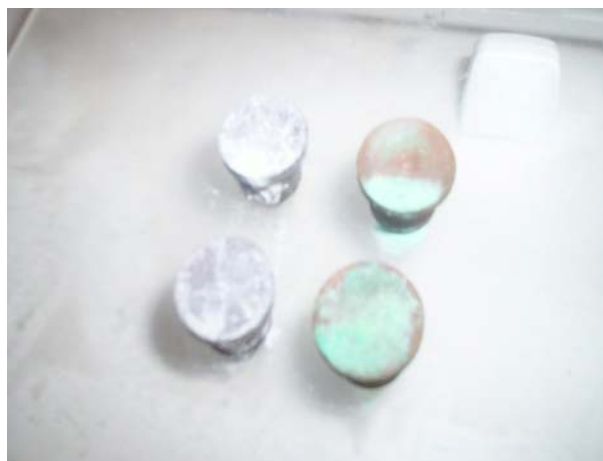
Figura 6.27. Latones con y sin recubrimiento después de 9 días en la cámara de niebla salina.
