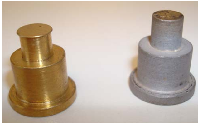
Figura 6.42. Probetas de latón con y sin recubrimiento. Se observa el borde en la parte superior de la probeta sin recubrimiento, rebaba generada por deformación plástica.
