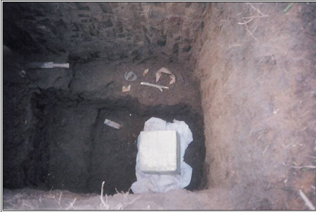
Figura II.2.1.- Pozo a Cielo Abierto (Fotografía en sitio).
