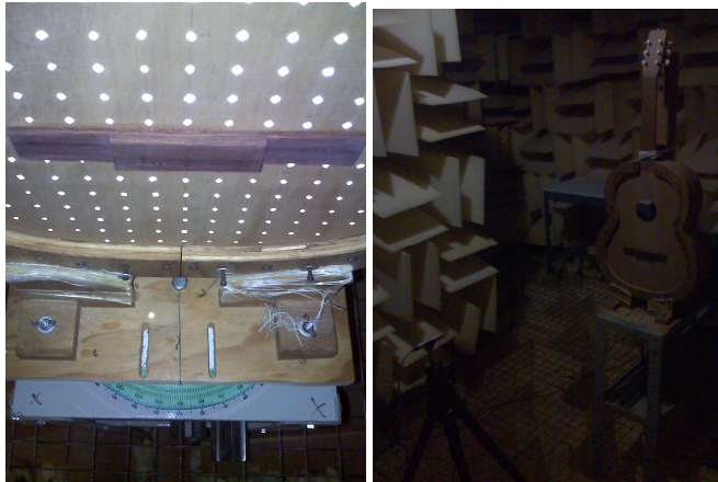
Figura 14. Montaje para medir la radiación sonora en la cámara anecoica.
