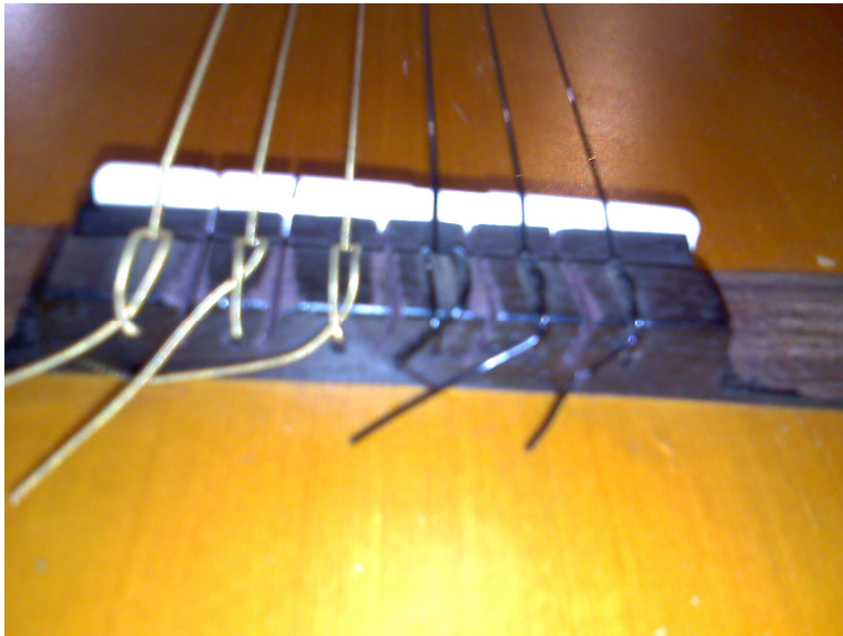
Figura 15. Ranuras en el puente de la guitarra Yamaha
