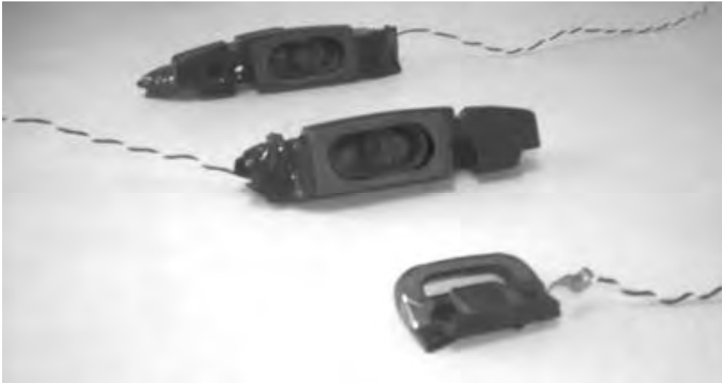
Figura 5-12: Fotografía de las bocinas utilizadas como fuentes de control en las pruebas experimentales de múltiples canales. Las bocinas superiores pertenecieron a una computadora portátil desmontada y la bocina inferior es del altavoz de un teléfono celular.
