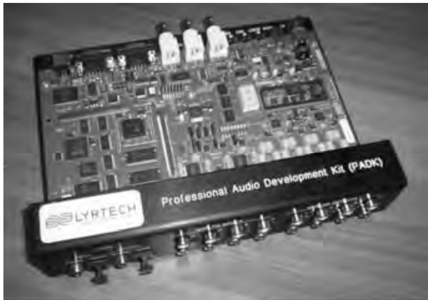
Figura 5-9: Fotografía de la plataforma de procesamiento digital de audio PADK, basada en el procesador DSP TMS320C6727 de Texas Instruments, utilizada en las pruebas experimentales de control activo de ruido con retraso mínimo.
