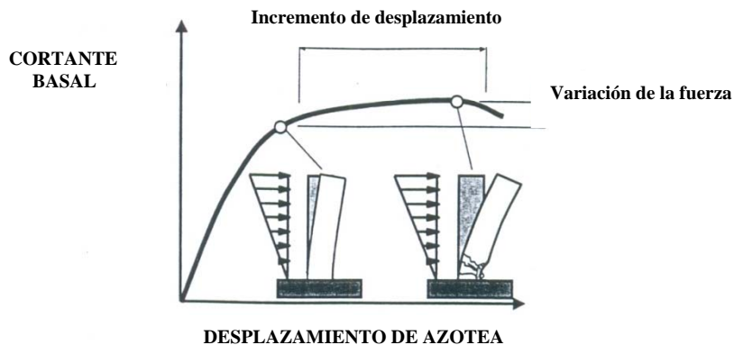
Figura 2.2 Comportamiento de un muro esbelto de concreto reforzado (fib 2003)
