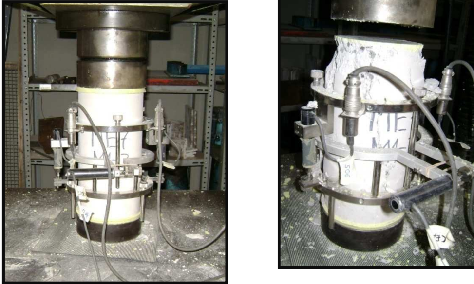
Figura 2.7. Prueba de compresión axial sobre cilindro de concreto
