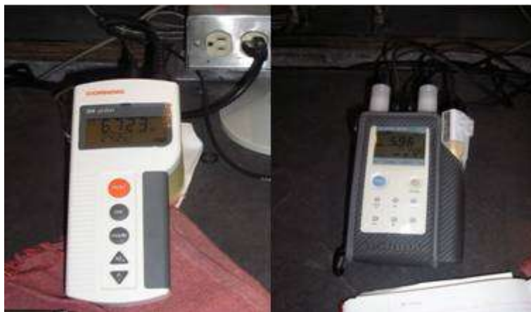
Figura 3.7.- Potenciómetro y conductímetro utilizados para las mediciones de pH y conductividad.
