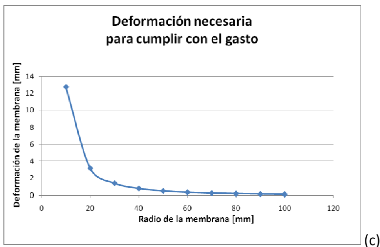
Figura 36. (a) Diseño de la bomba de membrana, (b) Soporte de la bomba de membrana, (c) Relación entre el radio de la membrana y la deformación necesaria para cumplir con el gasto.
