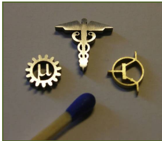
Figura 9. Piezas realizadas con máquinas de corte por chorro de agua suizas. [45]
