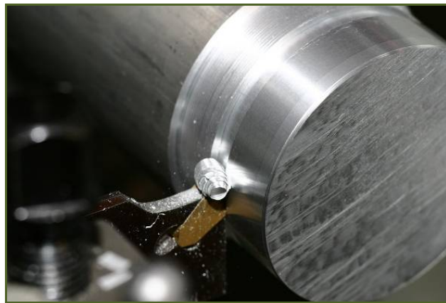
Figura 1. Mecanizado por arranque de viruta (Torneado convencional).
