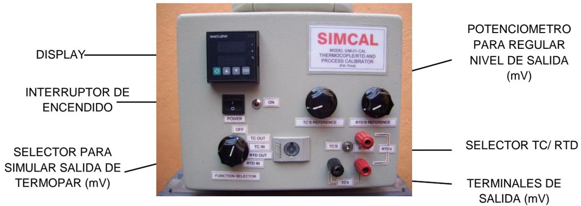
**FIGURA 6.1 CALIBRADOR DE CONTROLADORES DE TEMPERATURA Y SENSORES MARCA SIMCAL MOD. SIM-01-CAL.**
