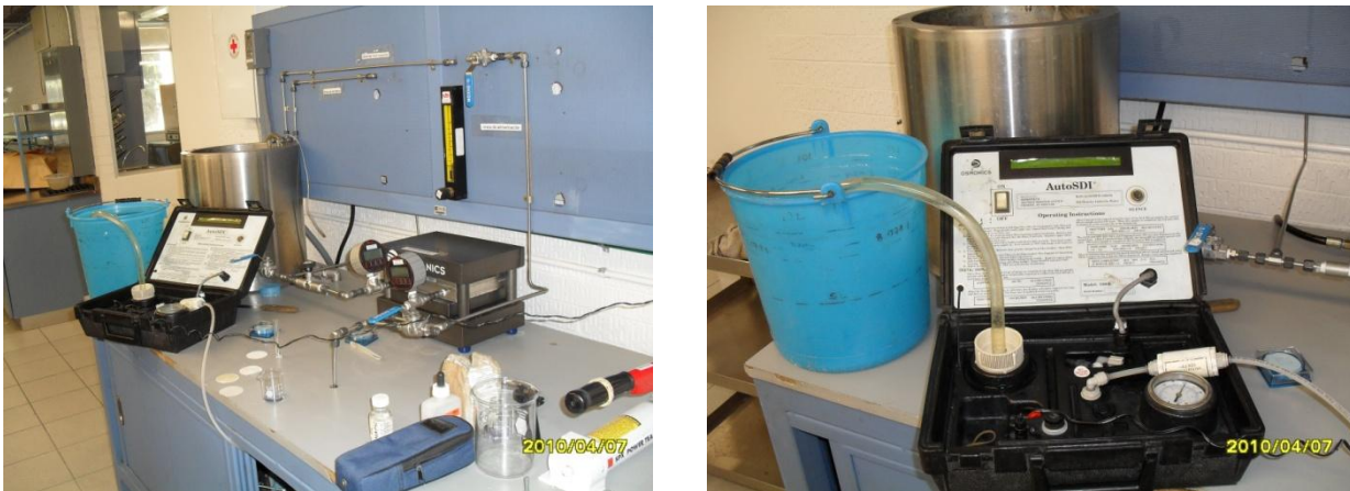
Figura A3.2. a) y b) Equipo para medición de SDI adaptado al módulo experimental.
