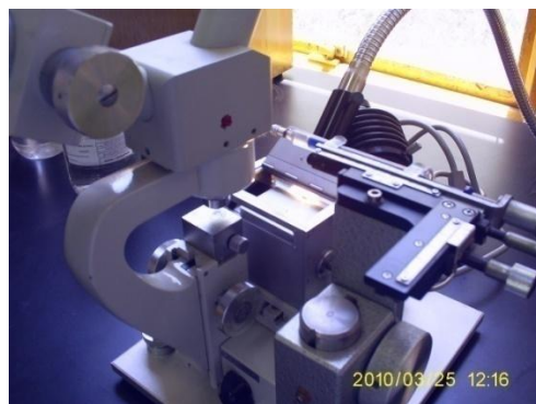
Figura 16. Goniómetro para determinación de ángulo de contacto del agua, Laboratorio de Superficies de la Facultad de Química de la UNAM.
