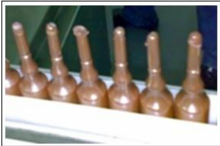
**Figura 4.18, Resultado de las boquillas desalineadas.**
