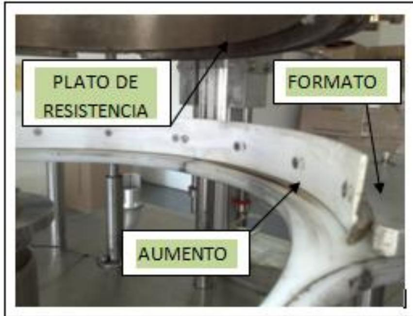
Figura 5.9, Guía para reducir la separación en apoyos.
