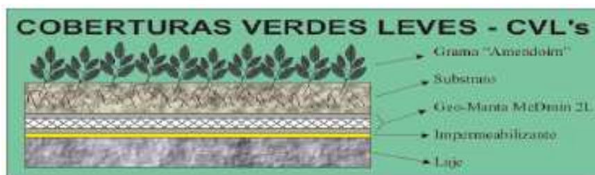
Figura 5.2.11 Diversas capas de una CVL. Vecchia, F. (2005).
