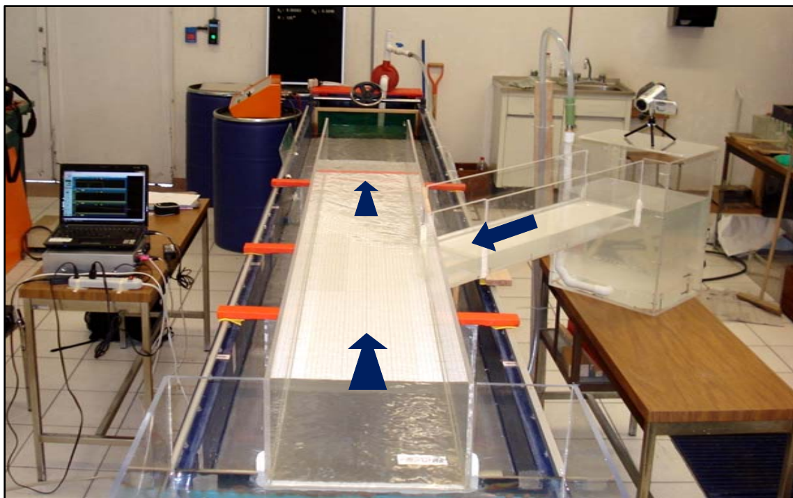
Fig. 4.6. Dispositivo físico con ángulo de unión de 135^\circ .
