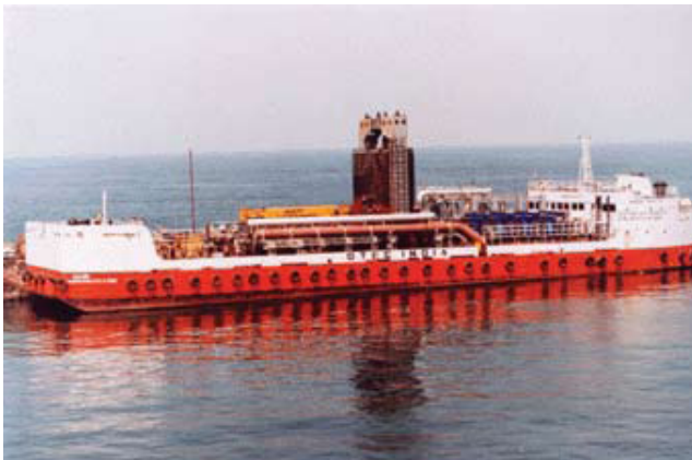
Figura II.13: Demostración de un dispositivo termodinámico OTEC de ciclo Rankine de 1MW (Saga University, Japón)
