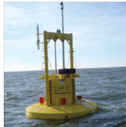
Figura III.2: POWERBOUY, Absorbedor puntual de libre flotación, mar de pruebas en Hawaii ( Ocean Power Technologies, USA )
