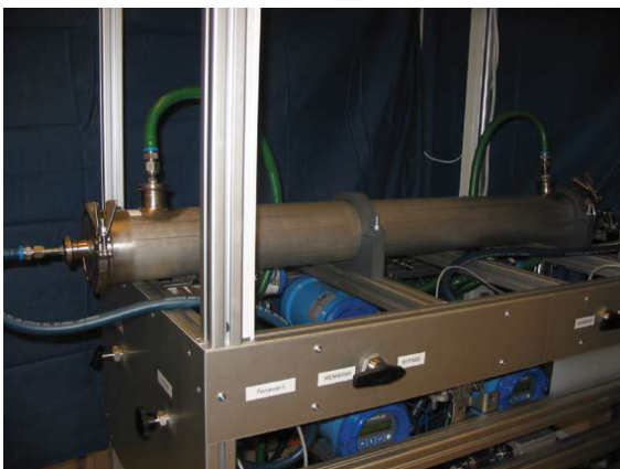
Figura II.15: Montaje experimental del desarrollo de membranas de potencial osmótico para el aprovechamiento de energía del gradiente de salinidad (Statkraft SF, Noruega)
