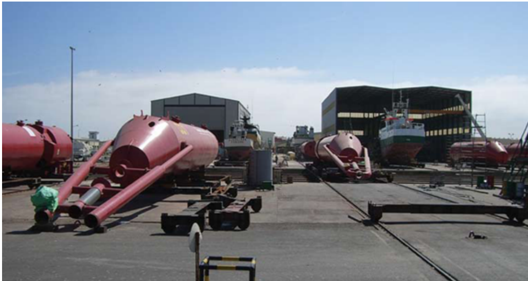
Figura III.7: PELAMIS, Dispositivo flotante articulado, montaje de la primera granja de dispositivos para mar adentro, frente al norte de Portugal ( Ocean Power Delevery, UK )
