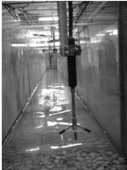
Figura C.1: Vectrino dentro del canal de olas
