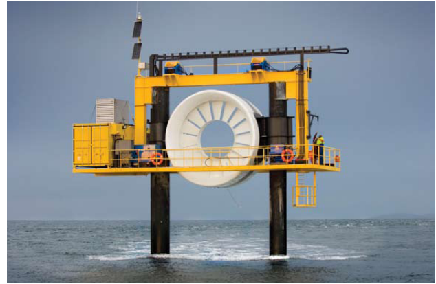
Figura II.9: OPEN-CENTRE TURBINE, Instalación en Orkney, Escocia ( OpenHydro, Ireland )
