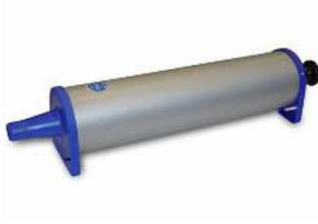
Figura 60. Jeringa de calibración
