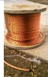
Imagen 22. Rollo de 250 [m] de cable de cobre desnudo de calibre 250 [kcmil].
