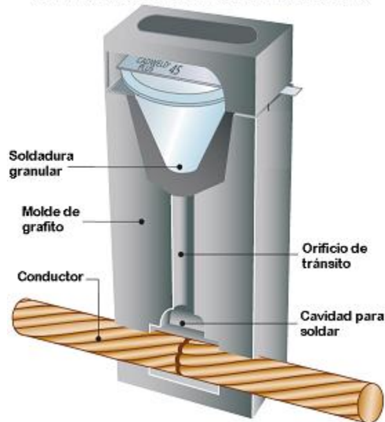
Figura 9. Molde de grafito, se aprecian todas sus cámaras interiores y los cables que serán unidos.
