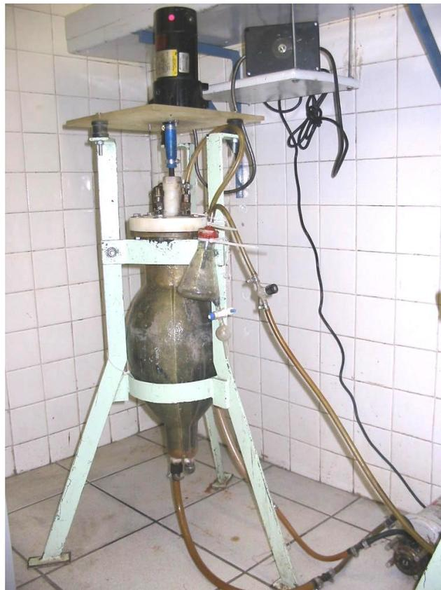
Figura 4.1 Digestor anaerobio mesofílico utilizado (dos unidades)
