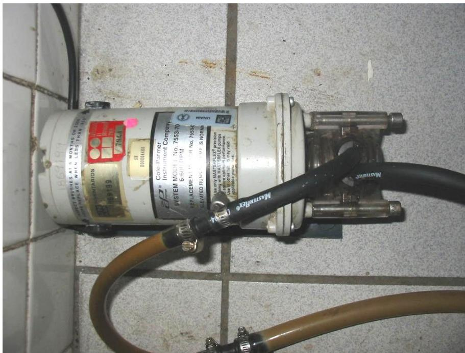
Figura 4.4. Arreglo de bomba peristáltica y motor para recirculación de los lodos utilizado (dos unidades).
