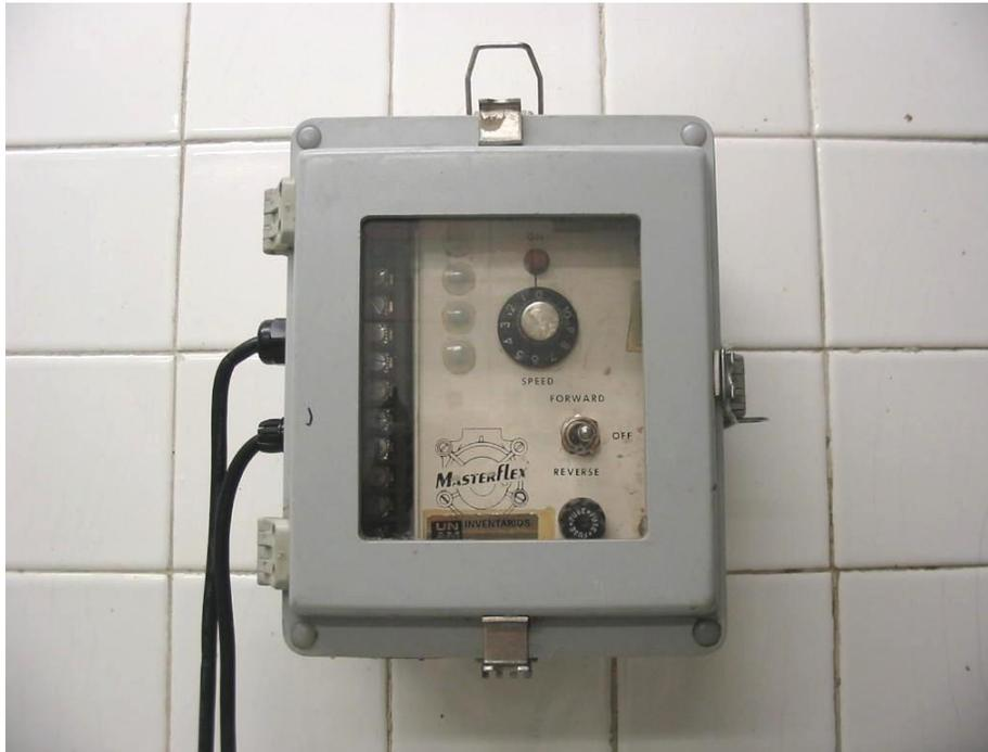
Figura 4.3. Controlador de velocidad de la bomba para la recirculación de lodos utilizado (dos unidades)
