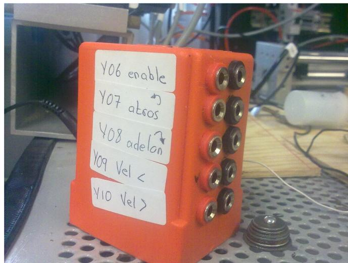
Figura Anexo 11: Módulo Control de Velocidad.
