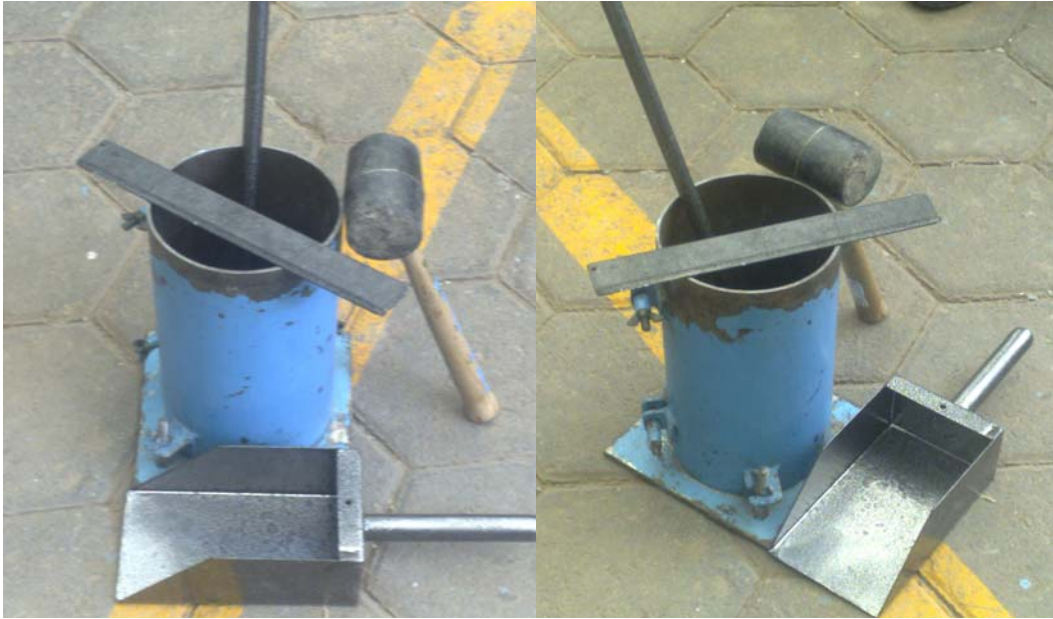
FIGURA 35 EQUIPO PARA ELABORAR CILINDROS DE CONCRETO
