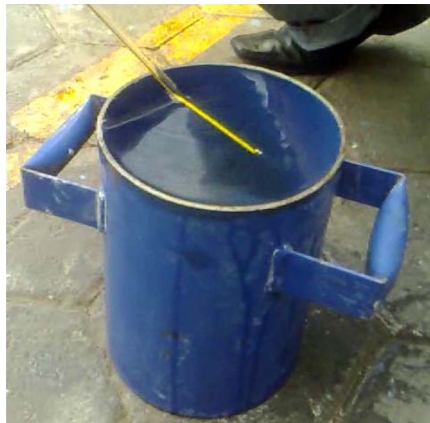
FIGURA 81 CÁLCULO DE LA MASA VOLUMÉTRICA DEL AGUA
