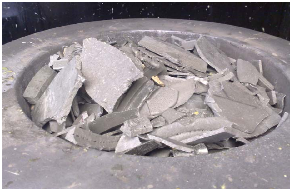
FIGURA 56 PREPARACIÓN DEL MORTERO DE AZUFRE
