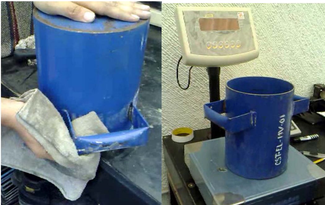
FIGURA 76 CONDICIONES DE LIMPIEZA PARA EL CÁLCULO DEL PESO “R”
