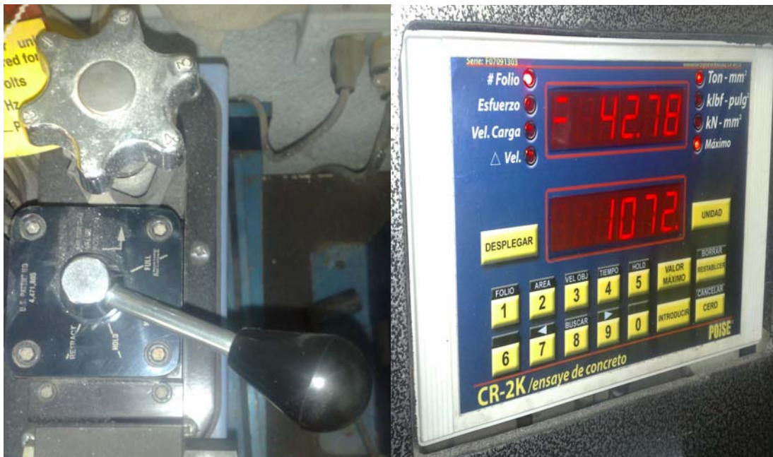
FIGURA 73 POSICIÓN No. 3 - APLICACIÓN CONSTANTE DE CARGA
