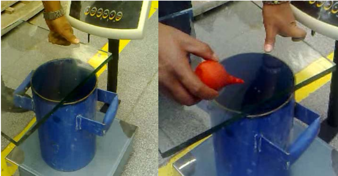
FIGURA 80 DETERMINACIÓN DEL PESO “R+V+A”
