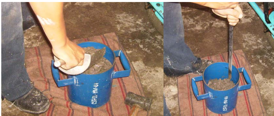
FIGURA 82 PROCEDIMIENTO DE LLENADO Y COMPACTADO
