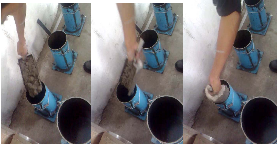
FIGURA 39 PROCEDIMIENTO DE VACIADO EN CILINDROS
