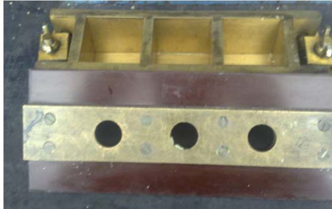
FIGURA 52 CUBIERTA PARA LA PREPARACIÓN DE ESPECÍMENES DE PRUEBA
