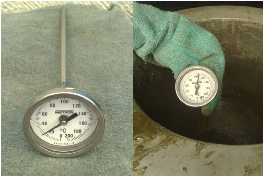
FIGURA 59 VERIFICACIÓN DE LA TEMPERATURA DEL MORTERO DE AZUFRE
