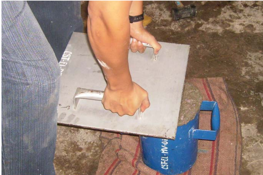
FIGURA 84 ENRASE CON PLACA METÁLICA - 1
