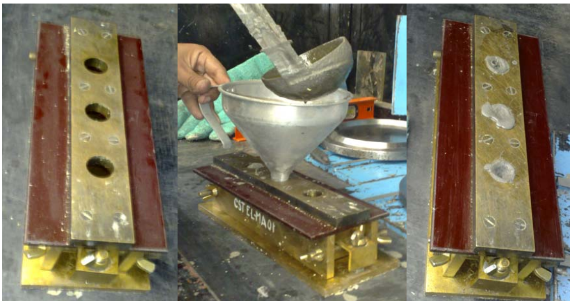
FIGURA 53 COLADO DE CUBOS DE MORTERO DE AZUFRE
