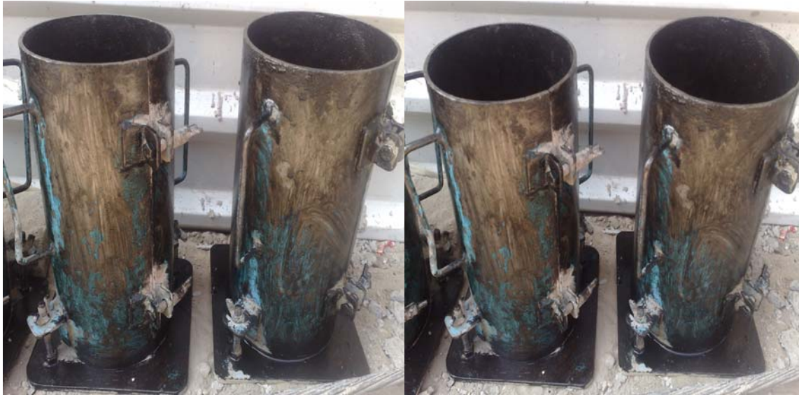
FIGURA 38 ESPECÍMENES CILÍNDRICOS REVESTIDOS CON DESMOLDANTE
