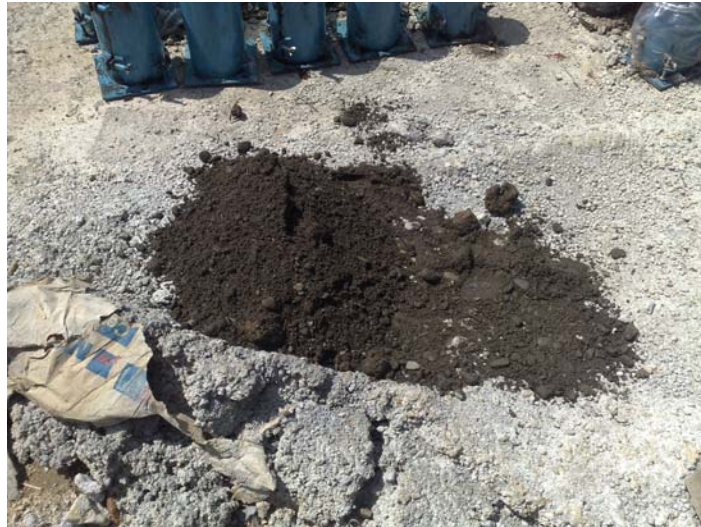
FIGURA 27 ARENA PARA NIVELAR EL EQUIPO DE REVENIMIENTO
