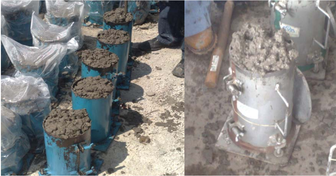
FIGURA 41 EXCEDENTE DE CONCRETO EN ESPECÍMENES CILÍNDRICOS
