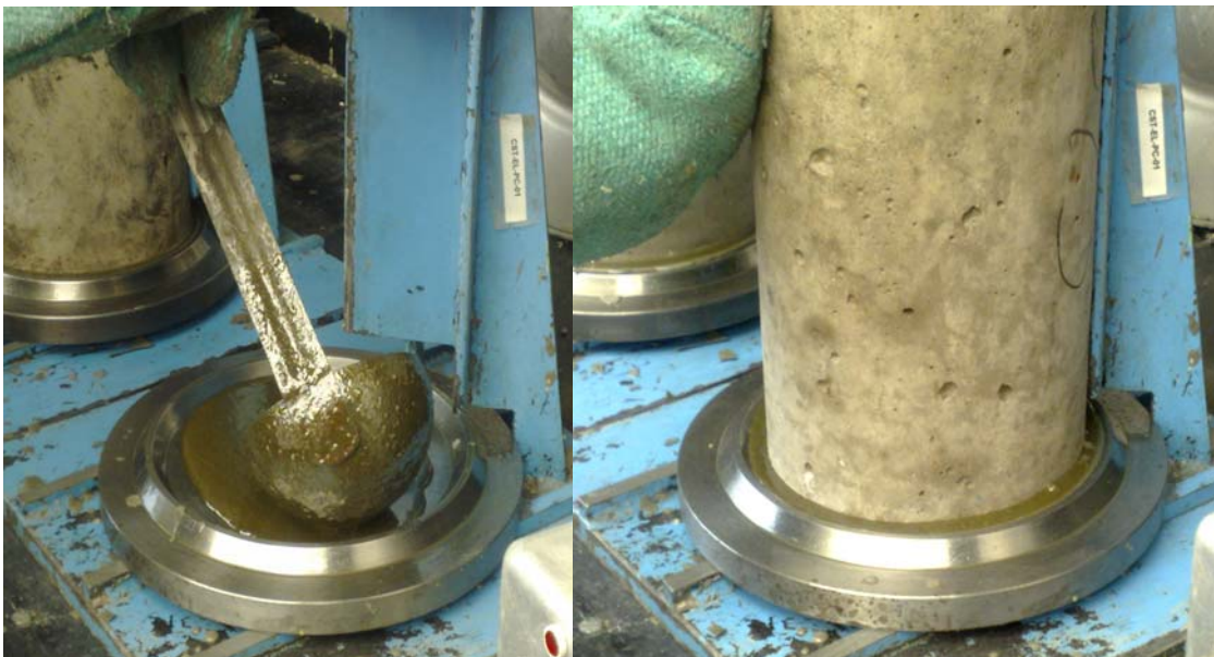
FIGURA 63 CABECEO DE CILINDROS DE CONCRETO
