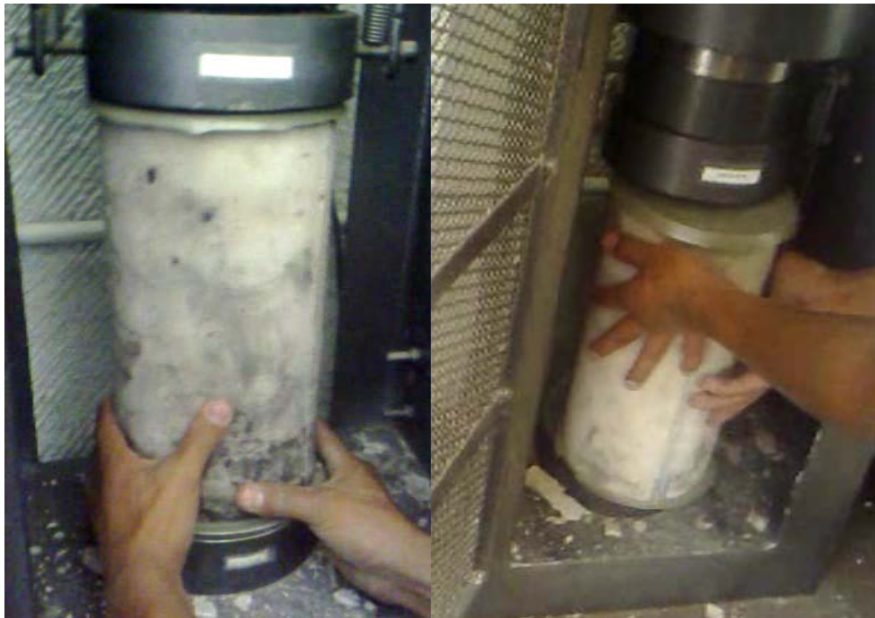
FIGURA 71 COLOCACIÓN Y CENTRADO DE CILINDRO PARA ENSAYE
