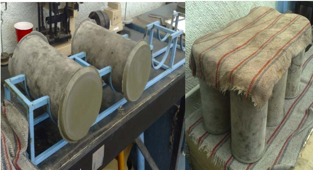
FIGURA 66 CONDICIONES DE HUMEDAD DESPUÉS DEL CABECEO
