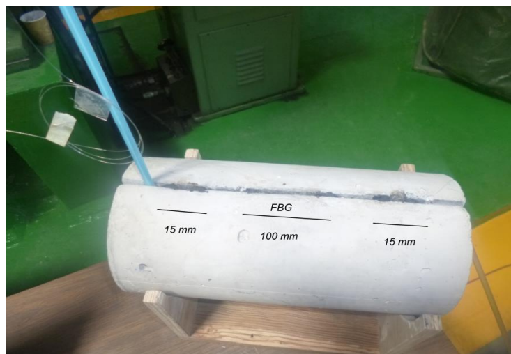
Figura 5.3 Instrumentación del cilindro de concreto con FBG (fotografía).
