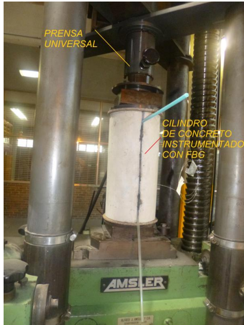
Figura 5.4 Imagen de instalación de la estructura de concreto instrumentada con FBG en máquina de compresión.
