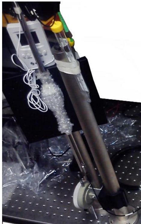
Figura 4.6 Instalación de FBG para sensado de tensión (fotografía).
