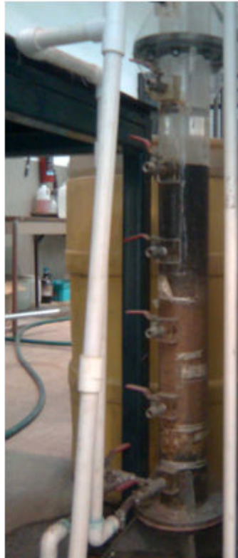
Figura 3.12. Columna de filtración de la planta piloto de Electrocoagulación
