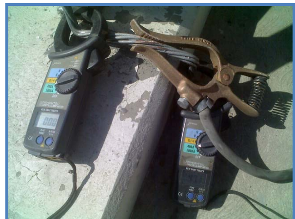
Fig. 6 Prueba de inyección de corriente
