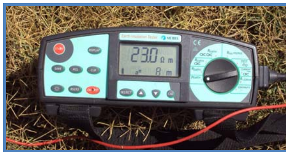
Fig. 3 Medición de resistividad del terreno
